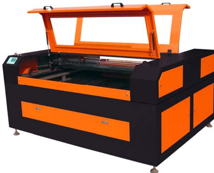
La serie Lasercut Mini pertenece a la gama básica de máquinas profesionales con tecnología láser CO<sub>2</sub> de baja potencia. Su estructura compacta, mesa motorizada con amplia área de trabajo, alta velocidad, bajo coste de mantenimiento y láser de 150W de potencia, hacen de este modelo una solución económica y rentable para multitud de aplicaciones, industrias y sectores.
